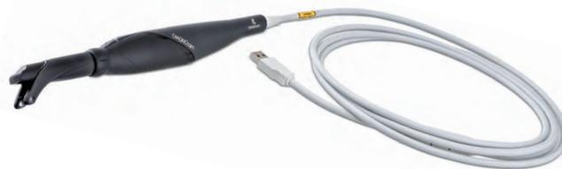
El DIAGNOcam de KaVo es un aparato compacto y móvil para la detección de caries. Utiliza la tecnología DIFOTI (transiluminación de fibra óptica digital en sus siglas en alemán) para analizar detalladamente el diente y apoya con ello el diagnóstico
