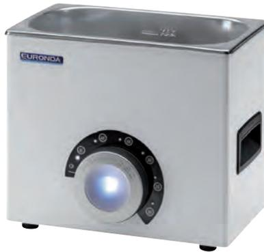
Caracterizada por una temperatura de trabajo constante a 60°C y tiempo ajustable entre 0 y 30 minutos, gracias al controlador central retroiluminado. Funciona con la tecnología Sweep Mode que distribuye de forma homogénea las ondas de ultrasonidos para una limpieza más uniforme y se ha equipado con un
